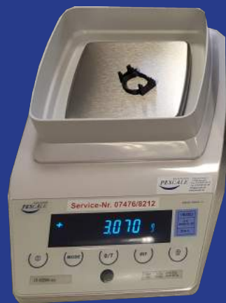
Einfache Stückzählwaagen bei Bedarf mit Drucker, Schnittstellen, usw.
